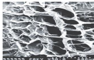
三维多孔网状结构
